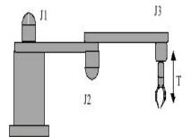
(a) The SCARA Robot RP41 (b) Schematic of the SCARA RP41 mechanism Figure 1. The SCARA Robot Manipulator (RP 41), (*Centre de Développement des Technologies Avancées, Algiers*)
