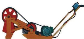
Fig. 4 the inertia rammer
