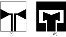
Fig. 10. The UWB bowtie antennas
