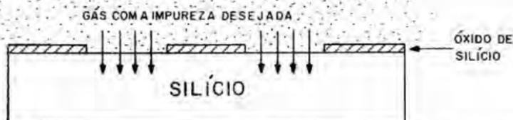
Figura 1.5 Difusão selecionada: o óxido de silício protege as regiões onde a impureza não deve penetrar
