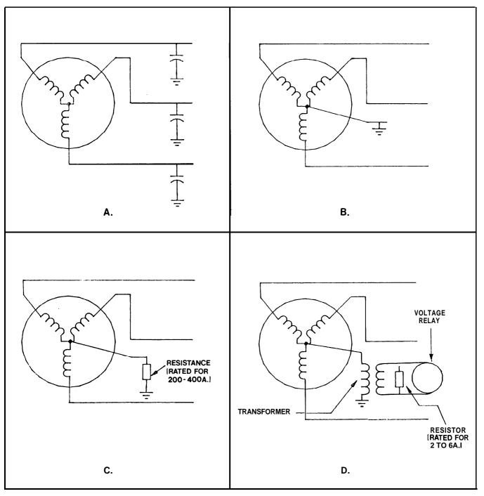
Figure 2-2. Types of system grounding. A) UNGROUNDED GENERATOR, B) SOLIDLY GROUNDED, C) LOW RESISTANCE GROUNDING, D) HIGH RESISTANCE GROUNDING
